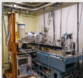
25素子 SSD/ 実験架台 (BL16B2) XAFS を用いた薄膜材料・粉末材料などの化学状態・局所構造解析が可能。同架台でトポグラフィを用いた半導体材料の評価、X線CTなどのイメージングが可能
