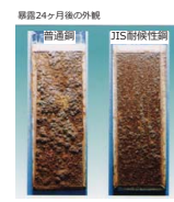
図 JIS耐食性鋼の耐食性
