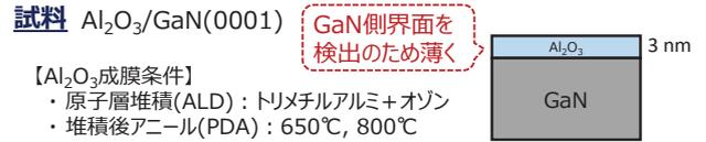
電気特性(破壊電界強度)は650°Cで高く、800°Cで低下
