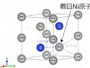
図7. FEFF計算で使った結晶構造(空間群P6 3 /mmc、格子定数 a = b = 3.90430 \text{ \AA} 、 c = 4.97687 \text{ \AA} のSiNi 2 )
