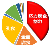
ステンレス鋼の腐食事例(水環境) 参照元: 損傷事例で学ぶ腐食・防食から編集 (財)大阪科学技術センター附属 ニューマテリアルセンター
