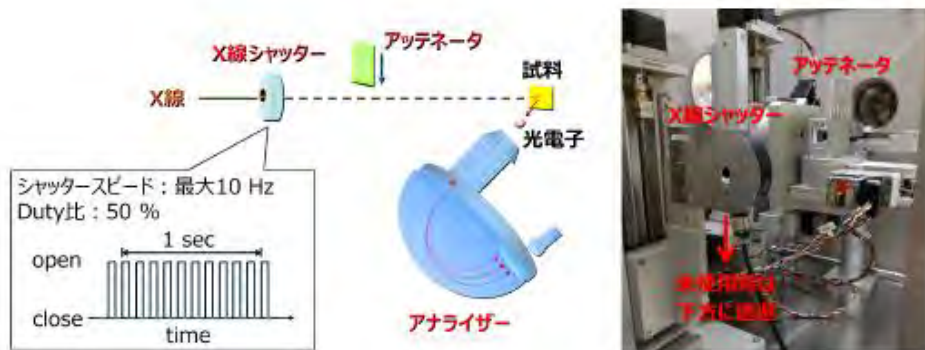
Fig. 4. 検証を実施した BL16XU の HAXPES 装置の構成
