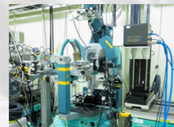
X線回折装置 (BL16XU) ※理研装置 薄膜材料、粉末材料、バルク材料などの構造解析、応力解析
