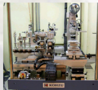
マイクロビーム形成評価装置 (BL16XU) デバイスや生物学的試料などの微小部点分析及び顕微イメージング
