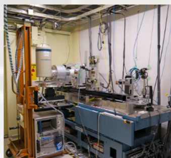
25素子SSD/実験架台 (BL16B2) XAFSを用いた薄膜材料・粉末材料などの化学状態・局所構造解析が可能。同架台でトポグラフィを用いた半導体材料の評価、X線CTなどのイメージングが可能
