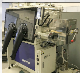
グローブボックス（共通設備） 大気に晒されると変質してしまう試料を大気非暴露で計測するための試料準備が可能
