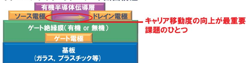
キャリア移動度は、有機半導体の分子構造、結晶構造などに依存しており、薄膜状態での結晶構造を把握することが重要→XRDにより有機半導体薄膜の構造評価を行なう。
