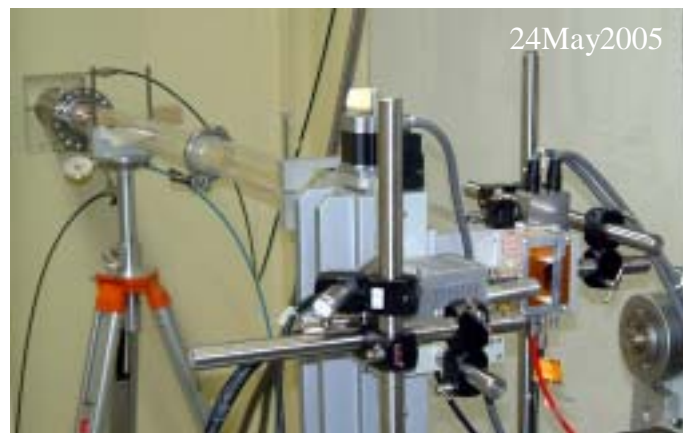
図1 新型SDDを用いたTi K 端測定 全景 BL16B2実験ハッチ内にて
