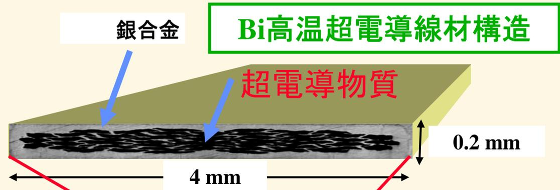
Bi高温超電導線材構造
