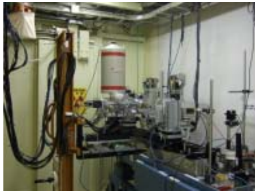
図1 BL16B2 に導入された 19 素子 SSD 検出器および新規 XAFS 実験架台
