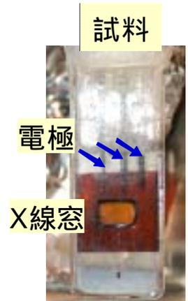
図 使用したポリイミド窓付き試料セル
