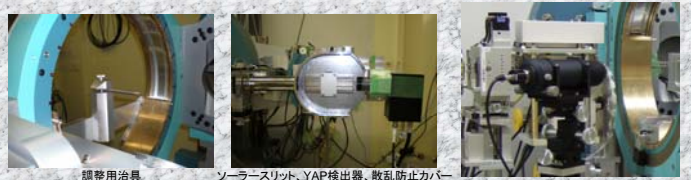
調整用治具 ソーラースリット, YAP検出器, 散乱防止カバー X線入射部, 試料位置確認用スコープ
