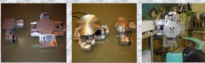
左: Rx/Ryステージ, 右: XYステージ チェッキング治具 実際の使用例
